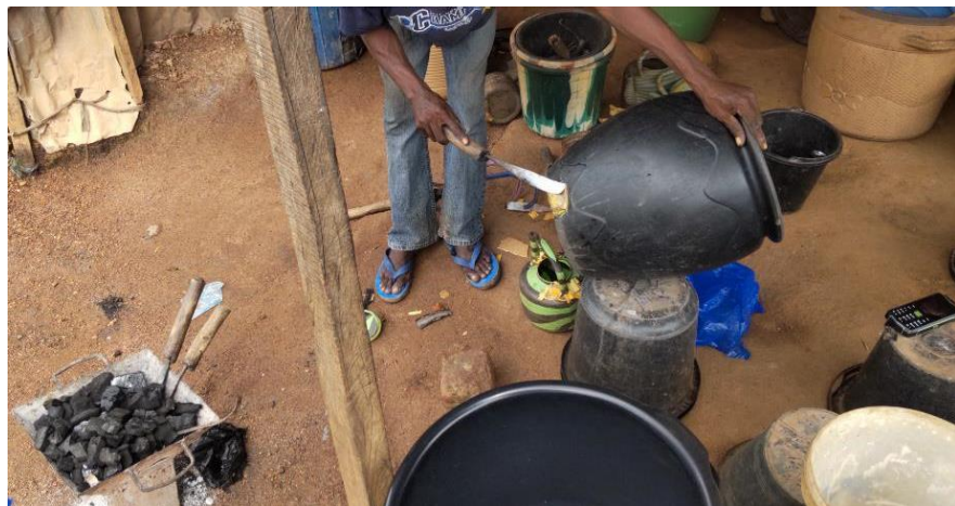
割れた硬質プラスチックの溶接による修理
