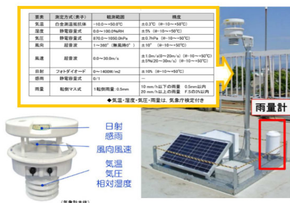
図 2. POTEKA (気象データ観測装置)
