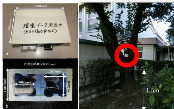
図 1. 測定装置と樹木への設置の様子
