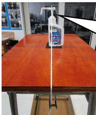
PP ロープの中心が、ポンプの軸の中心に来るようにする
